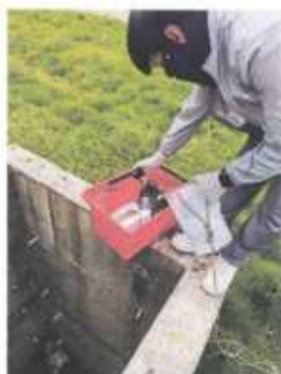
生活污水总排口废水采样
