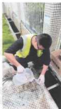
雨水排放口废水采样
