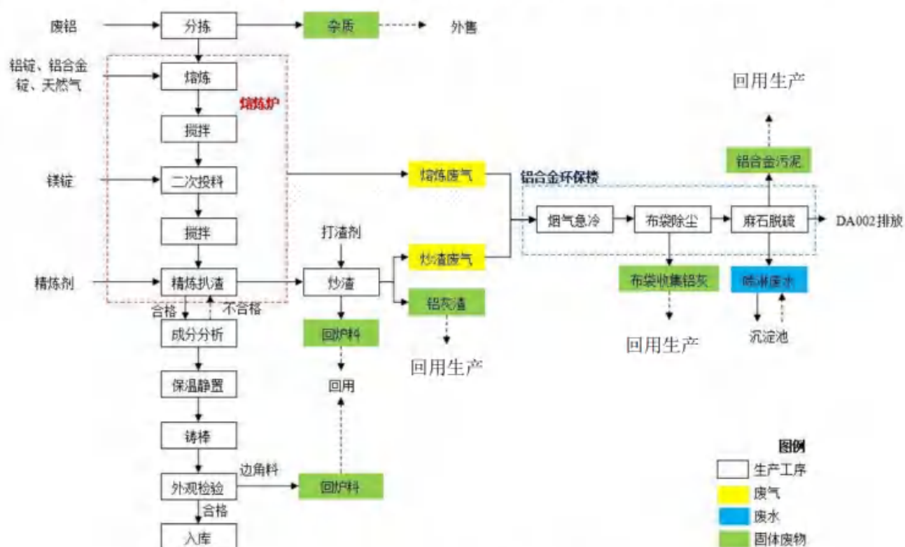
图 3.2-3 现有项目铝合金生产工艺流程及产污环节图
